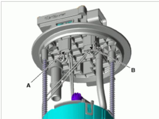
3. 拆卸固定夹(A)，并分离燃油供油管(B)。
