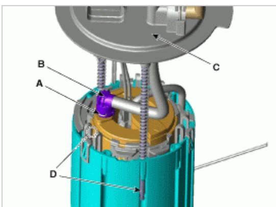
5. 释放固定挂钩(A)，并拆卸储油杯。
